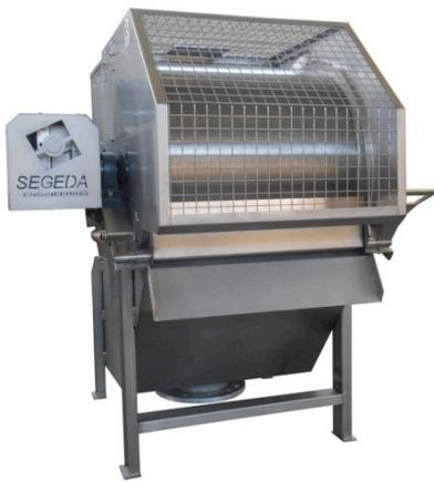
**MP SCREEN** è corredato di un sistema di controlavaggio interno al cilindro, da attivarsi ad intermittenza nei casi di reflui aventi caratteristiche particolarmente difficili ed intasanti.
